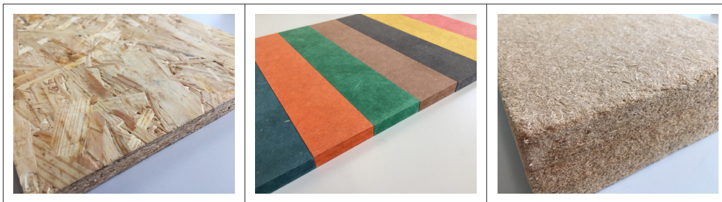
Grobspanplatte (OSB Oriented Strand Board)..... Mitteldichte Faserplatte (MDF)..... Weichfaserdämmplatte..... Konstruktionsplatte (Dampfbremse)..... Möbelfronten, Bekleidungen (sichtbar eingesetzt)..... Wärmedämmung..... Bekleidung Wand, Boden..... ..... .....
